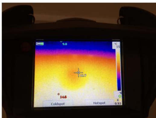
Bruk av termografi for å identifisere kalde overflater, og evt fukt eller vann i konstruksjon.
