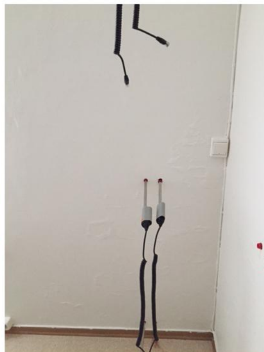
Metodisk fuktmåling av konstruksjon. Målt RF og lufttemperatur både 5, 10 og 20 cm inn i konstruksjon, i ulike høyder.
